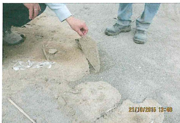
Fotografía 3: La capa superficial observada se encuentra aglomerada superficialmente llegando a formar láminas superficiales sus características son similares a las fibras que se procesa en la planta TRUPAL y se encuentra alrededor de la zona de descarga de sus efluentes industriales a la playa El Charco.
