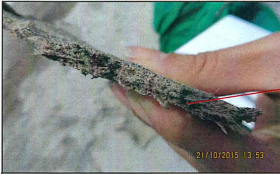
Fotografía 4: Las “costras” o lámina superficial apelmazada presentan características similares a las fibras que se procesan en la planta La Libertad de TRUPAL y además estas se presentan en el punto de descarga de los efluentes industriales al mar siendo este punto la única descarga industrial en este sector.
