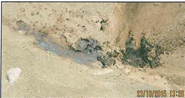
Fotografía 22: Se identifica el afloramiento de licor negro sobre la superficie del terreno al otro lado del dique de contención de la poza de evaporación y sedimentación de licor negro N° 6.
