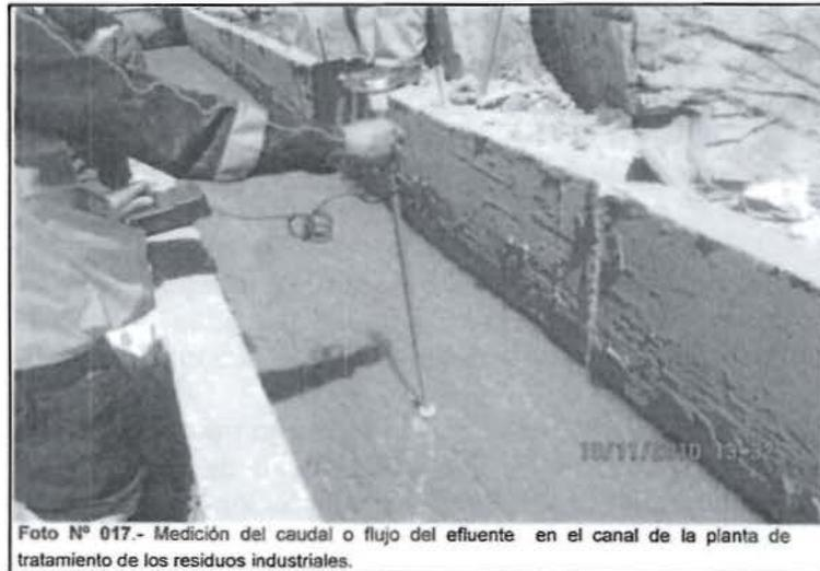
Foto N° 017.- Medición del caudal o flujo del efluente en el canal de la planta de tratamiento de los residuos industriales.
