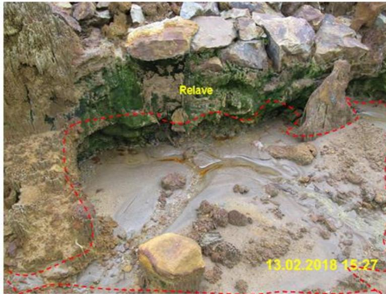
**Fotografía N° 101:** Vista cercana del relave que ha sido arrastrado hacia la parte baja del depósito RELAV-MO-LL-4, como consecuencia de las precipitaciones pluviales.
