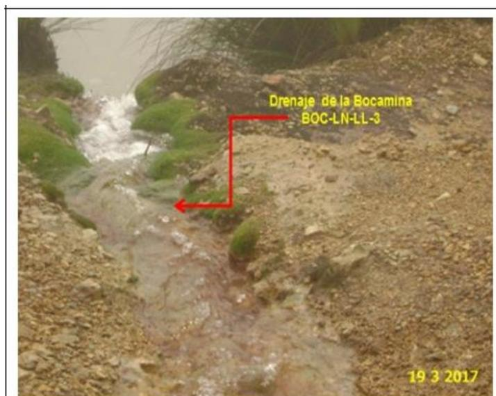
**Fotografía N° 17:** Drenaje de la bocamina BOC-LN-LL-3, que discurre cuesta abajo de la vía de acceso y de la desmontera DESM-LN-LL-24.
