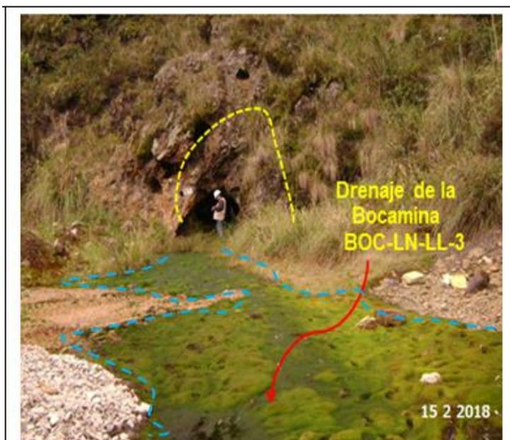
**Fotografía N° 49:** Drenaje de la bocamina BOC-LN-LL-3, ubicada en la zona Los Negros, se observa que este discurre por la vía de acceso, no existen estructuras hidráulicas.
