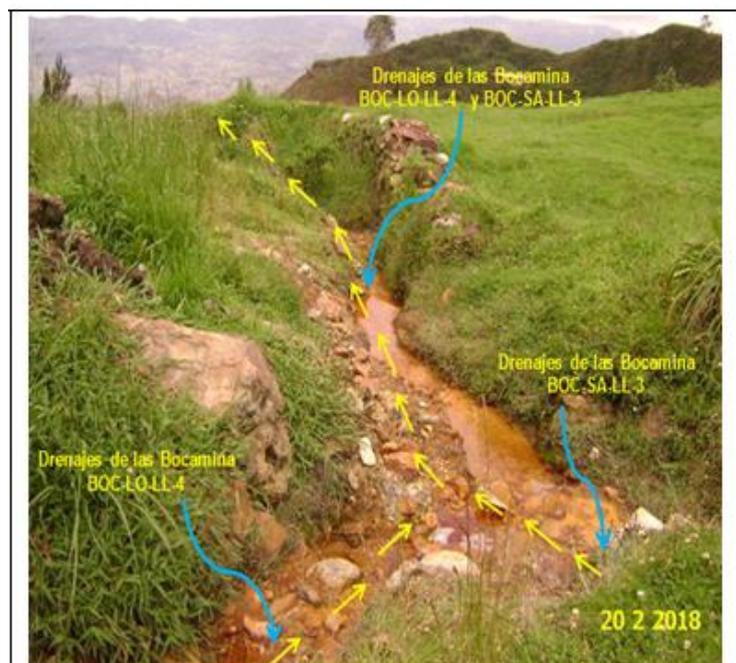
**Fotografía N° 45:** Drenajes de las bocaminas BOC-LO-LL-4 y BOC-SA-LL-3., que se dirigen en dirección a la carretera asfaltada para su posterior descarga al río Hualgayoc.
