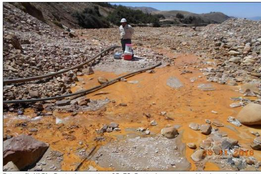
Fotografía N° 79: Punto de muestreo SD-F5: Punto de muestreo ubicado en la descarga de la poza de Neutralización, luego del subdrenaje que se encuentra en el lado Norte del PAD de lixiviación de la Fase 5, con coordenadas (Datum WGS-84) E: 820375, N: 9118449.
