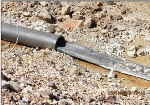
Fotografía N° 45: Otra vista del ingreso de la manga LDPE hacia la tubería HDPE y en el suelo solución pregnant.
