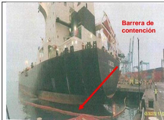
Foto N° 15. Vista lateral izquierda del área impactada por el derrame de producto IFO 380, nótese la barrera de contención sobre el contorno de la embarcación B/T Camisea.
