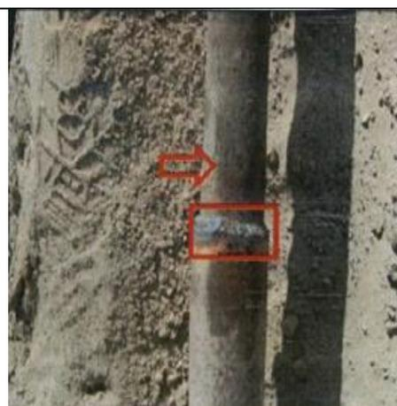
Fotografía N° 2: Se observa la unión de la tubería reparada, asimismo, se verifica que la tubería presenta indicios de oxidación, proceso inicial de corrosión
