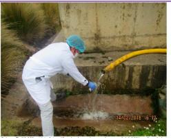
Fotografia Nº 263: Vista fotográfica donde se observa al personal del OEFA realizando la toma de muestras para análisis microbiológicos: Coliformes totales y fecales, luego se tomó muestra para el análisis de metales totales.
