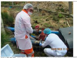
Fotografía Nº 247: Vista fotográfica donde se observa al personal del OEFA realizando la tom de muestras para análisis microbiológicos: Coliformes totales y fecales, luego se tomó muestr. para el análisis de metales totales.
