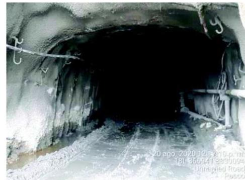
Fotografía N° 4: Tubería HDPE 4" hacia interior mina (Nv. 4050).
